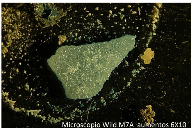
Figura 3. Coloración azul característica de nitratos vistos al microscopio.
