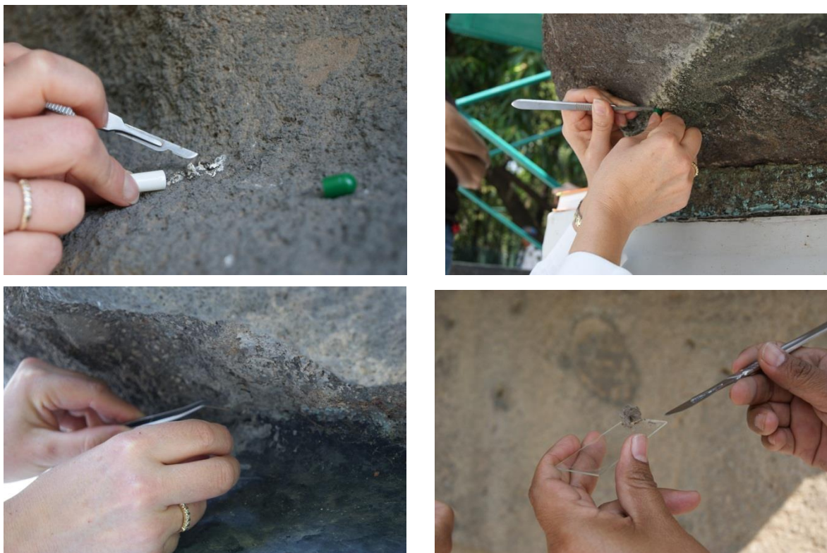
Figura 1. Toma de muestras para identificación de sales en diferentes áreas del monolito.
